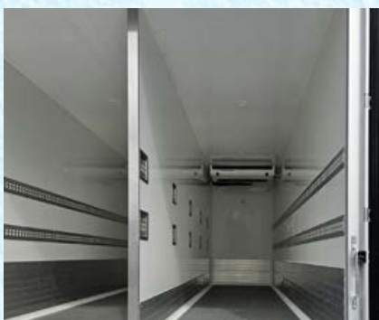
Longitudinal partition wall
