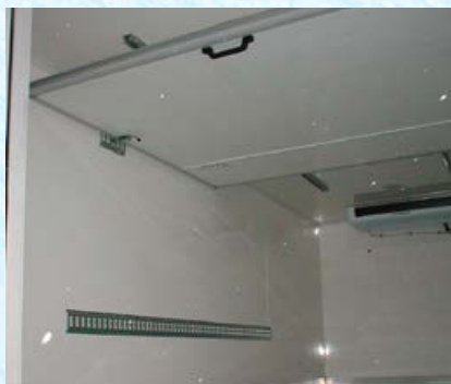
Quertrennwand verschiebbar und kippbar
