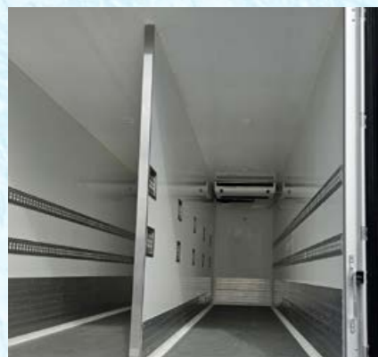
Longitudinal partition wall
