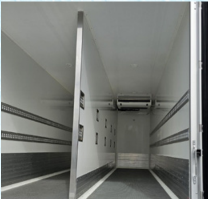
Longitudinal partition wall
